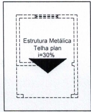
PLANTA DE COBERTURA ESCALA 1:100
